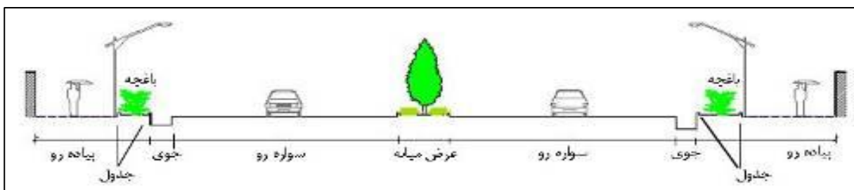
شکل ۲-۷- نمای کلی مقطع عرضی یک معبر
