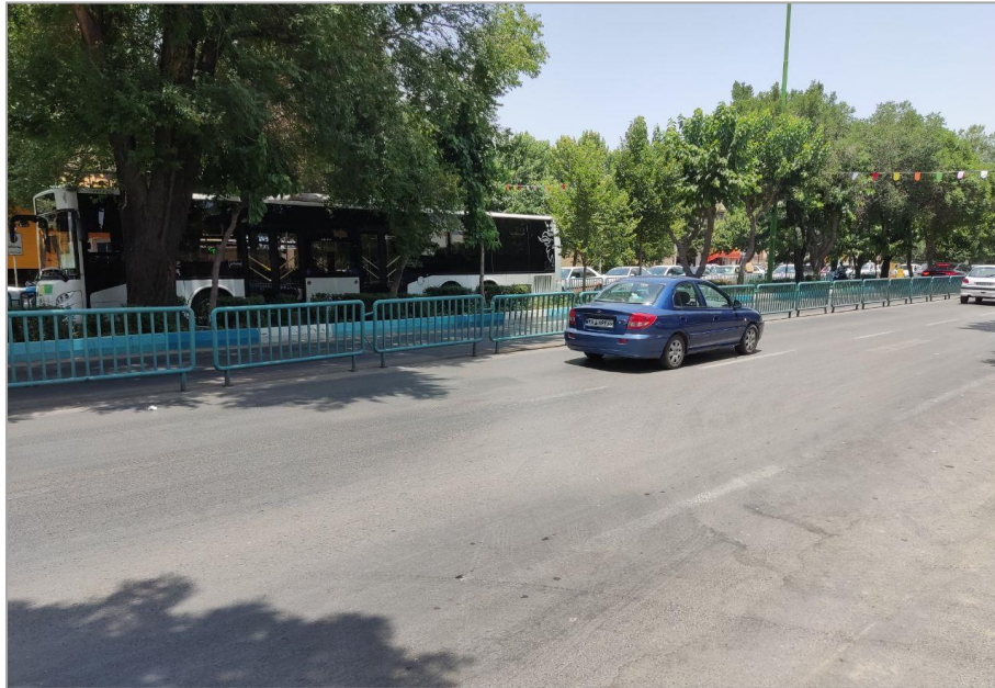
شکل ۳-۳- جداسازی خطوط ویژه به وسیله نرده آهنی
