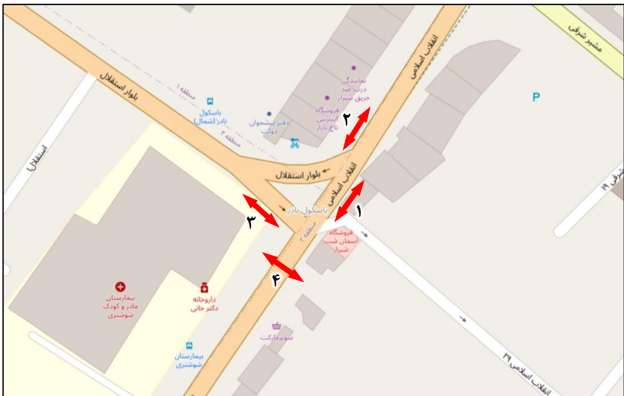
شکل ۱-۱۶- مقاطع شمارش احجام پیاده در ایستگاه استقلال
