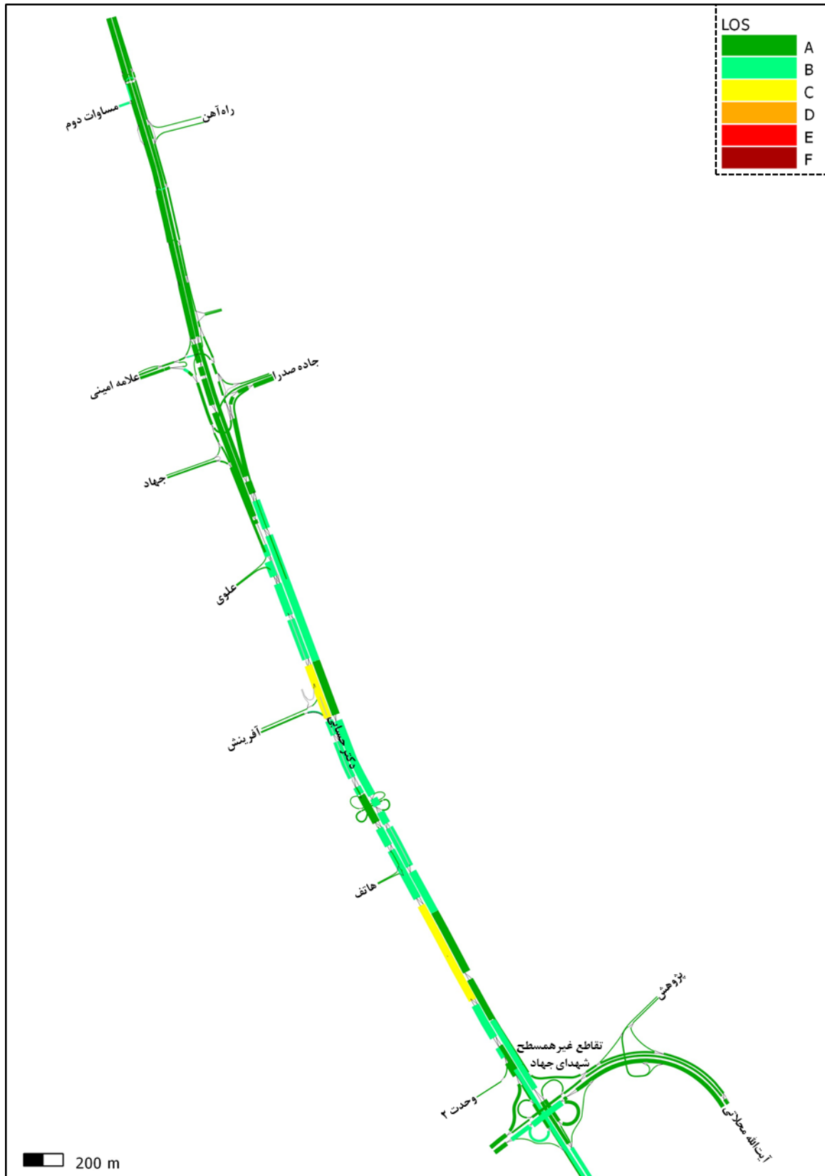
شکل ۲-۱۰- سطح سرویس شبکه معابر کریدور خط ۳ در محدوده تقاطع غیرهمسطح شهدای جهاد تا ایستگاه راه آهن در اوج صبح (با بهره‌برداری از مسیر قره‌پیری)
