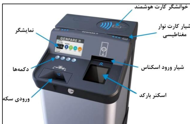
شکل ۳-۱۸- یک دستگاه اعتبارسنجی پرداخت کرایه با قابلیت پذیرش انواع ابزارهای پرداخت کرایه [۲۰]
