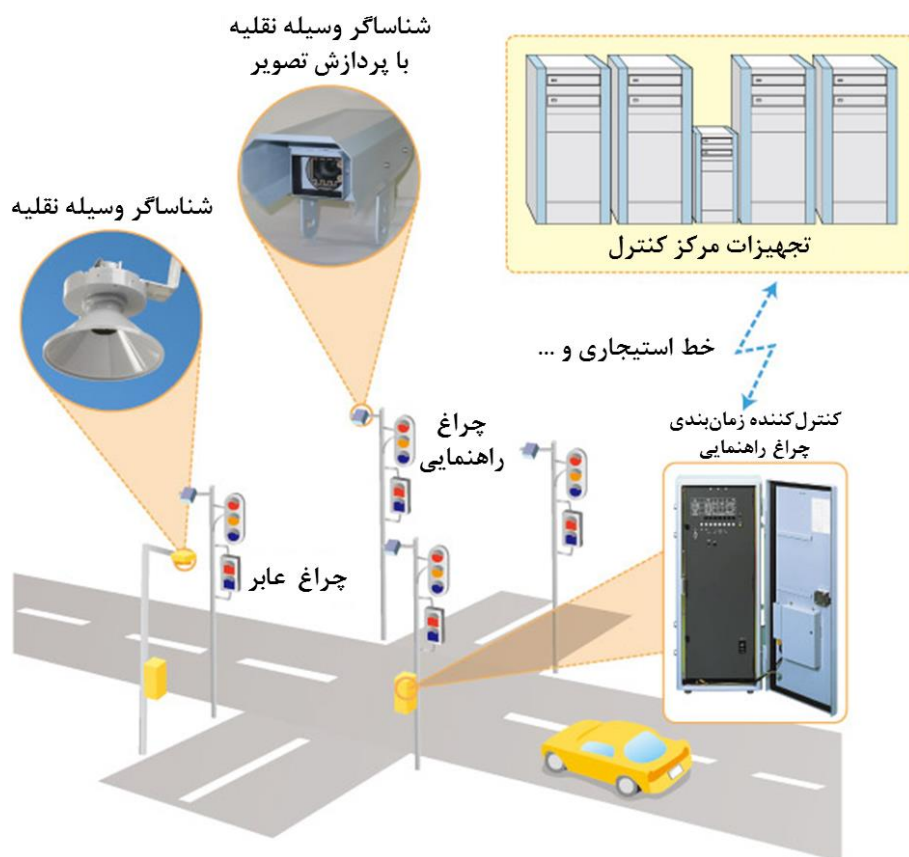
شکل ۳-۲۵- معماری یک سامانه کنترل چراغ راهنمایی [۱۰]
